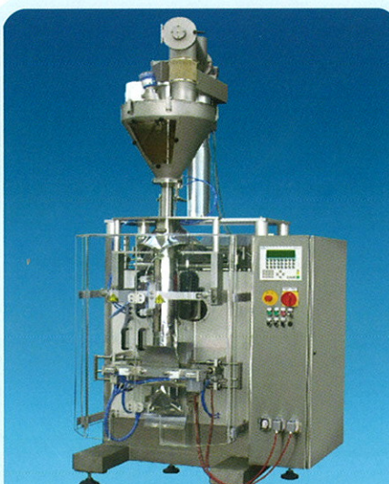
Ensacheuses verticales pour tous produits Exemple : pour produits pulvérulents avec doseur à vis
